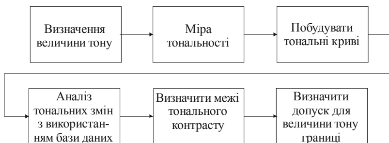
Рис. 2 Блок-схема для ілюстрації методу випробування для встановлення допустимих параметрів відтворення величини тону на приграничних ділянках
