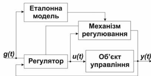
Рис. 1. Блок-схема системи адаптивного управління з еталонною моделлю
