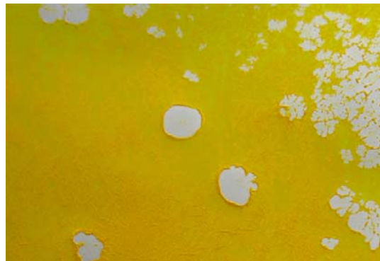
Рис. 2. Дефект "кратероутворення", через погане розтікання УФ-фарби по полімерній плівці
