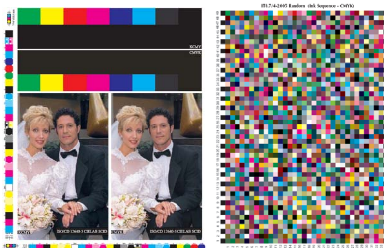
Рис. 1. Модельний тест-оригінал для дослідження накладання плашкових полів C+K , M+K , Y+K , CM+K , CY+K , MY+K , CMY+K і K+C , K+M , K+Y , K+CM , K+CY , K+MY , K+CMY (зліва) та тест|ціль| IT8.7/3 для|за| характеристики процесу управління кольором принтера СМУК (справа)
