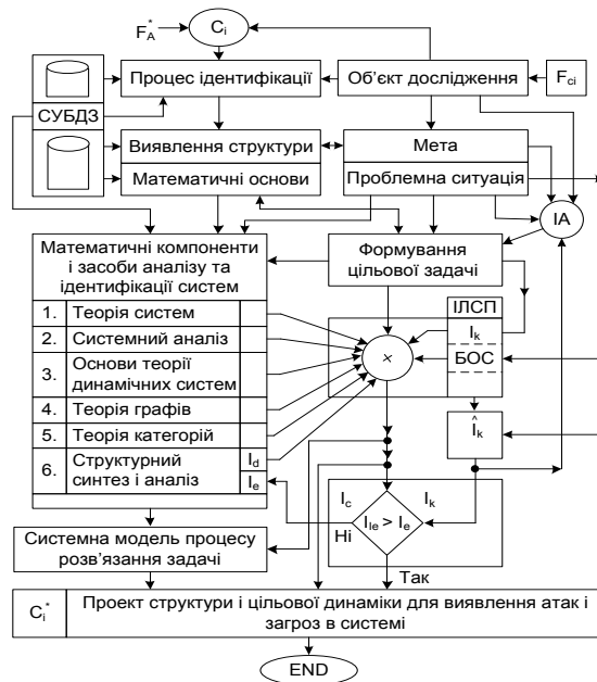
Рис. 5. Схема системології формування структури об'єкта та оцінки динамічного стану, де IA – інтелектуальний агент; F_{ci} – цілезадаючий фактор активізації; СУБДЗ – система управління бази даних і знань; ІЛСП – інтелектуальний логічний системний процесор синтезу структури; БОО ( Sit(OV/t)\tau ) – блок обробки системної ситуації в об'єкті управління в момент t на інтервалі часу \tau ; I_k – критерій системних вимог до якості; \hat{I}_k – оціночна якість; I_e – еталонна якість; H_i: (\hat{I}_k \geq I_k) \Rightarrow [Strukt(OV) \leftrightarrow R(F_{ci})] – перевірка на відповідність продукту синтезу цільовому завданню; I_d – критерій якості динаміки поведінки системи; F_A^* – фактор активізації впливу на систему.
