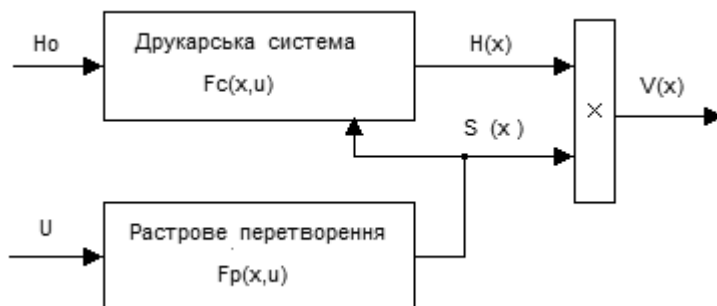
Рис. 1. Функціональна схема автотипної тонопередачі
